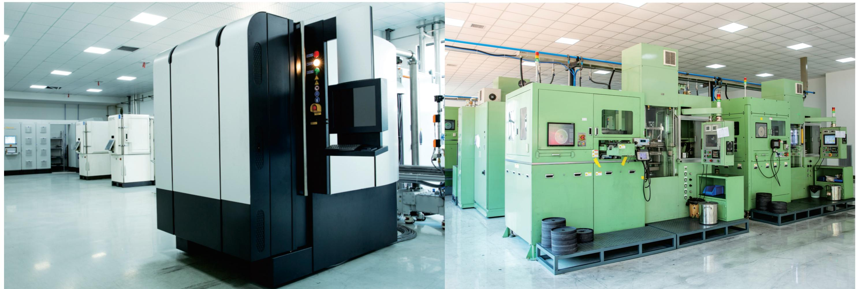
公司拥有从粉末原料制备、模具制作、压制成型、压力烧结、研磨加工、涂层和涂层后处理的完整刀片制造工艺装备生产线。公司混合料装备喷雾干燥制粒系统，先进的工艺和设备确保原料物理性能和表观成型性能最佳。压制成型采用世界上最先进的电动直驱自动压力机，其高精度和高性能满足了产品精度，高稳定性等要求。烧结方面应用最适合可转位刀片内在质量和表查质量要求的最先进压力烧结设备。研磨加工采用数控周边磨床等，保证产品形状和精度要求。涂层也是采用世界上最先进的物理涂层和化学涂层。先进的涂层后处理设备，保证产品性能的更加优化。全套世界一流的一流的生产线确保每一片刀片品质如一。
